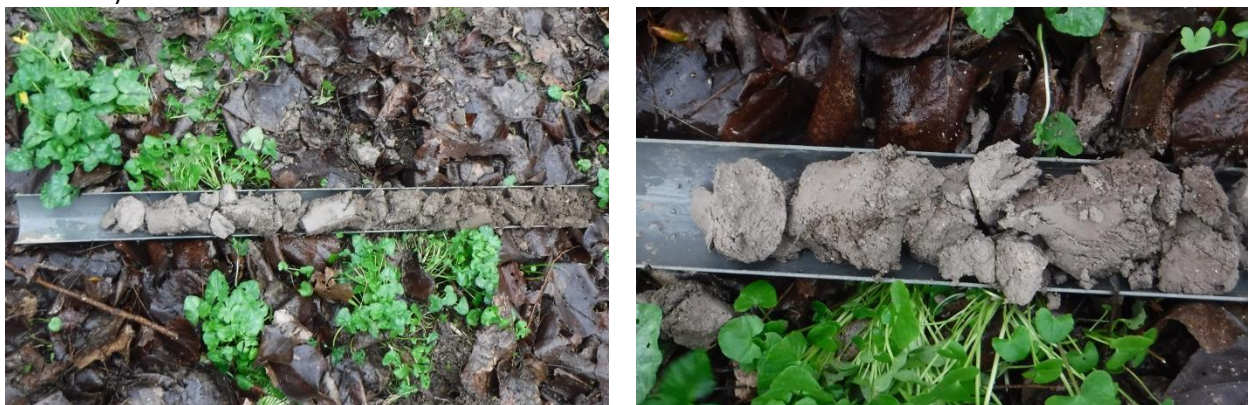
Photographie du sondage avec éclaircissement du sol bien visible (à gauche) et zoom sur le sondage entre 80 et 100 cm de profondeur avec décoloration du sol (trace d'hydromorphie).
